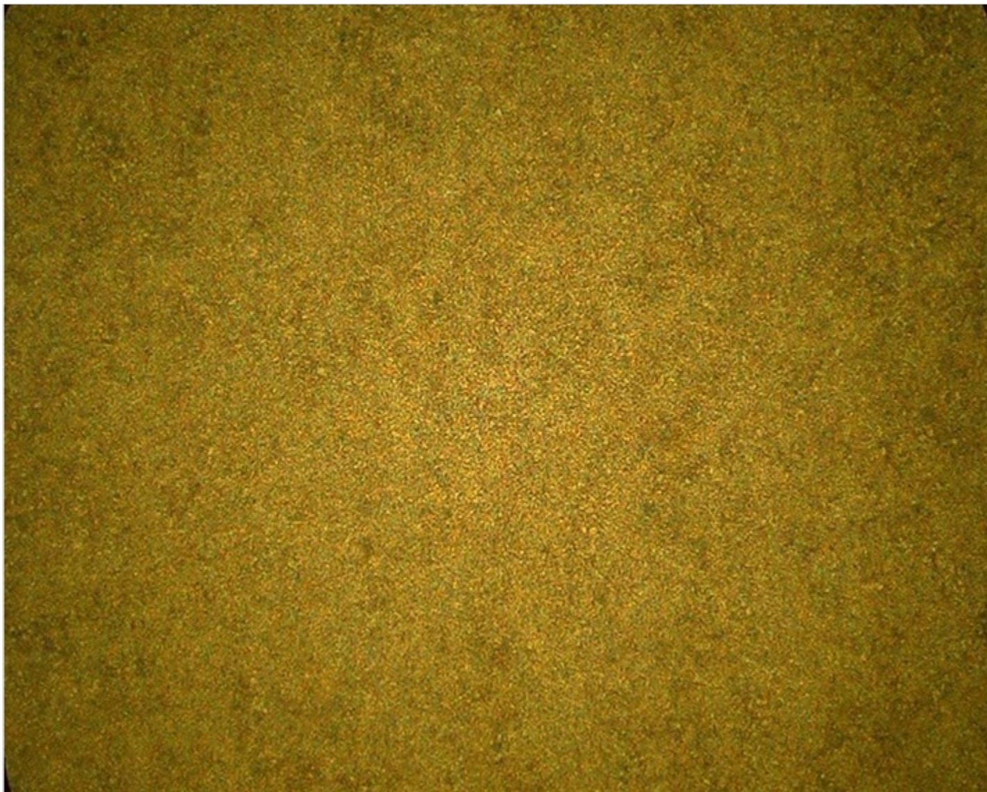
Mikroštruktúra materiálu vonkajšieho krúžku ložiska. Popustený martenzit a veľmi jemné disperzné karbidy chrómu (biele bodky)
